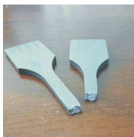
图11 拉伸断口宏观形貌
